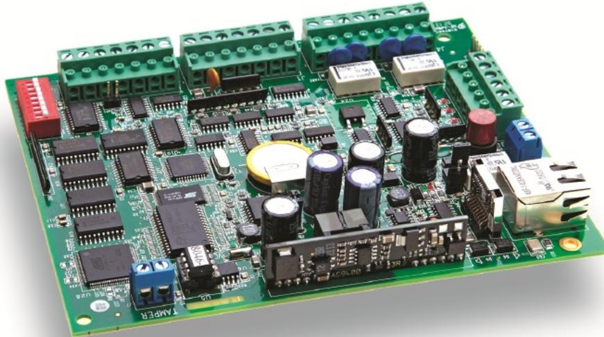
**SMART-PoE es una controladora de acceso de una puerta y dos lectores diseñada para entornos de alta seguridad.**
